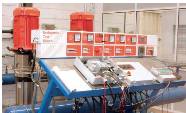
Banco hidráulico propio equipado con 7 bombas
